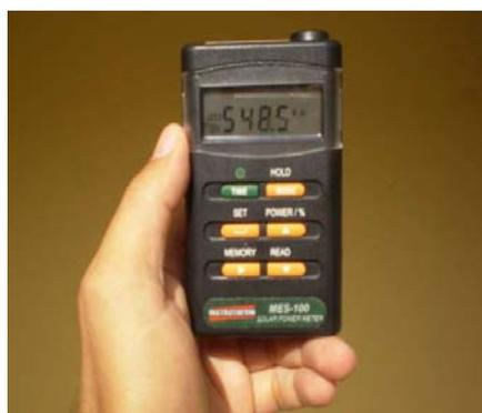
Figura 3.12. O medidor de energia solar digital indicando 548,5 W/ m<sup>2</sup>.
