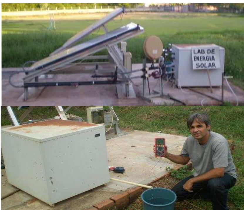
Figura 2.11. SAS de circuito indireto com seus componentes e controlador eletrônico de temperatura.
