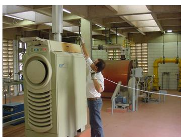
**Figura 6.26 – Coleta de amostra dos gases de exaustão da microturbina**
