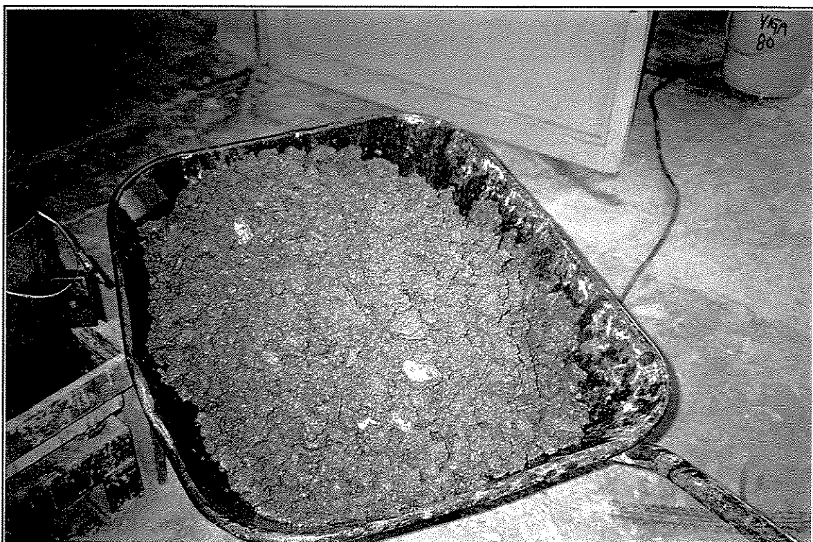
FOTO 6 - Aspecto do concreto fresco produzido com o entulho reciclado.
