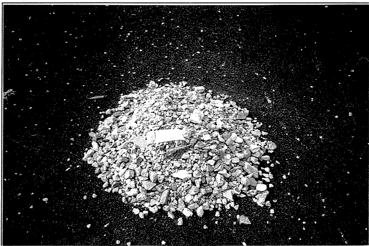
FOTO 4 - Parcela graúda do entulho utilizado como agregado.
