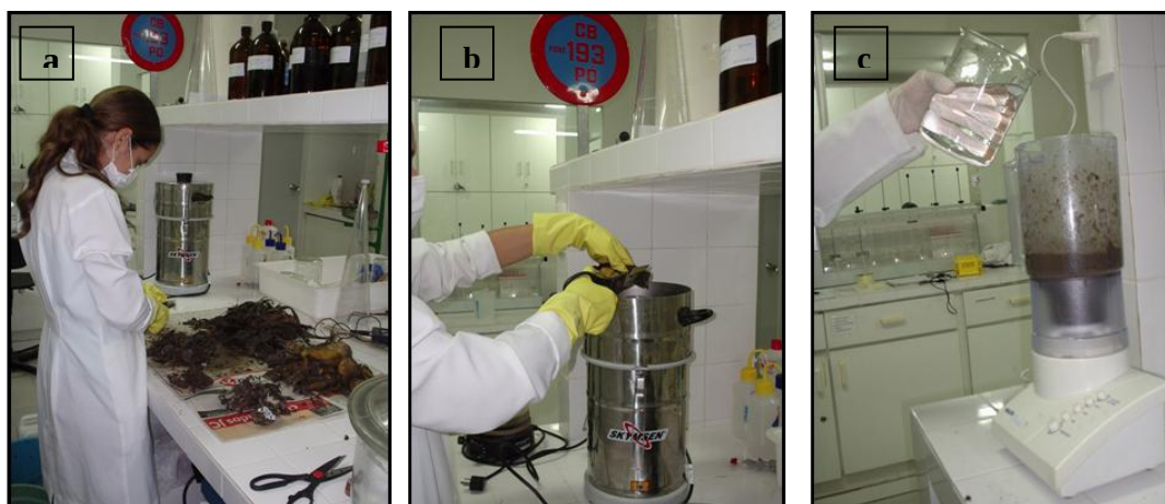
Figura 3.2. Primeiras etapas da preparação do Ensaio BMP: (a) Quarteamento e caracterização dos resíduos (matéria orgânica); (b) Redução do tamanho (corte e trituração em processador industrial); (c) Adição de água e mistura em liquidificador.
