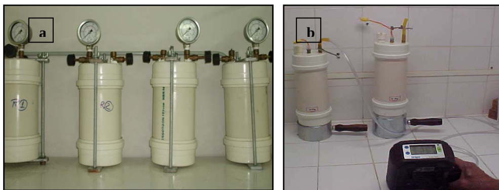
Figura 3.9. (a) Biorreatores utilizados no ensaio com diferentes umidades; (b) Leitura da concentração dos gases dos biorreatores através do equipamento Drager.
