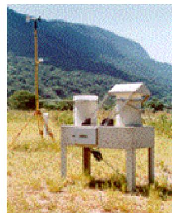
Figura 4.1: Coletor automático Graseby/GMW APS 78100 de deposição úmida e seca. Fonte: MAIA; MELLO (2004).
