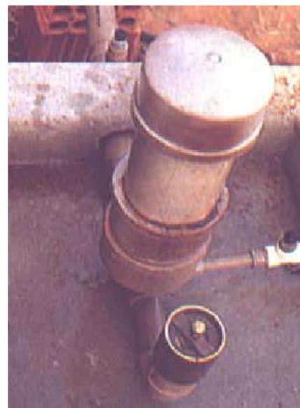
Figura 5.34: Carneiro hidráulico construído com tubos e conexões.
