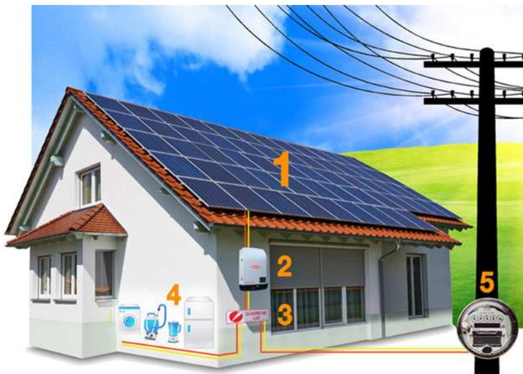
1. **Painéis Solares:** os módulos fotovoltaicos são instalados nos telhados ou áreas externas e são os responsáveis por converter a energia luminosa proveniente do sol em energia elétrica. A energia produzida pelos módulos é em corrente contínua (CC);
