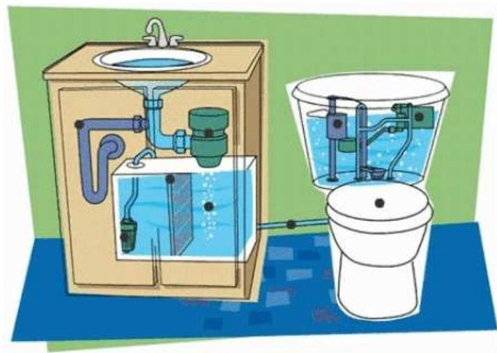
Com bombeamento – água usada p/ caixa de descarga
